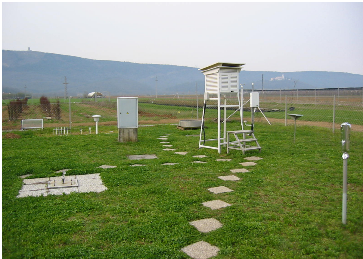
Slika 18: Meteorološka postaja v Biljah z vgrajenimi merilniki vode v tleh, za merjenje vsebnosti vode v tleh (Foto: ARSO)
