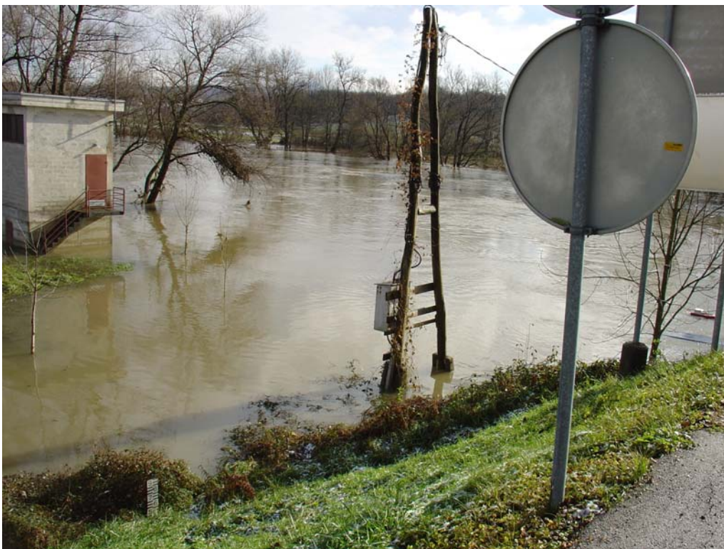
Slika 4. Reka Kolpa v Metliki (na vodomerni postaji), slikano 28. novembra v smeri toka. Levo spodaj je vodomerna letev, desno v sredini je merilec pretoka ADCP (rdeč čolniček). Avtor slike je Tilen Čepar.
