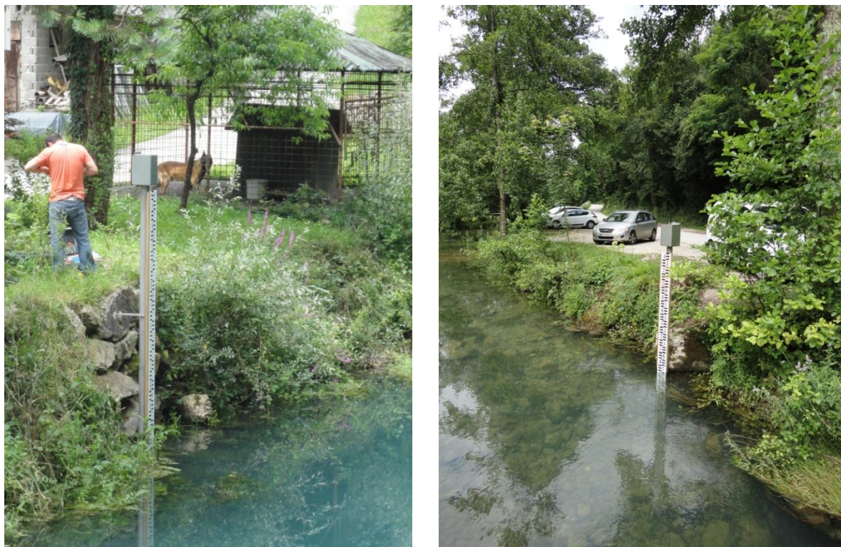
Slika 1. Posodobitev merilnega mesta izvira Krupe (levo) in vzpostavitev novega merilnega mesta na izviru Studene (desno) v juliju 2014 (Foto: M. Hočevnar)
