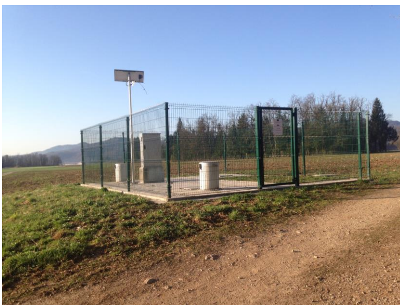
Slika 3. Merilno mesto za spremljanje gladine podzemne vode na Meji na Sorškem polju, 29. marec 2017 (Foto: Urška Pavlič)
