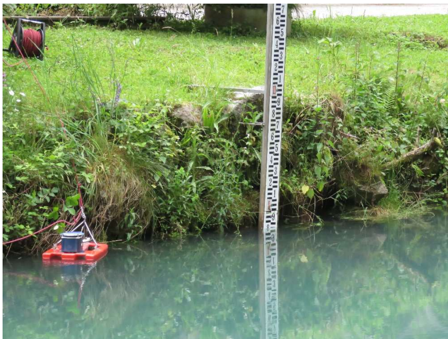
Slika 2. Izvajanje kontrolnih meritev pretoka na območju izvira Krupe, avgust 2019 (foto: arhiv ARSO) Figure 2. Discharge control measurements of Krupa spring area in August 2019 (photo: ARSO archive)
