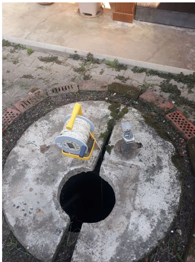
Slika 1. Izvajanje kontrolne meritve gladine podzemne vode na vaškem vodnjaku v Ključarovcih avgusta 2019 (vodonosnik Mursko polje) (foto: arhiv ARSO)
