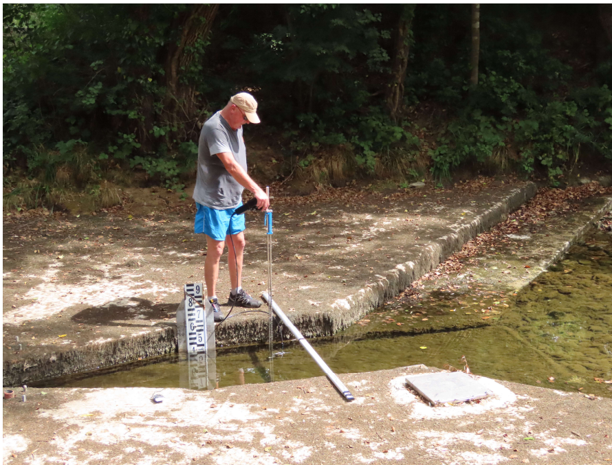
Slika 1. Izvajanje meritve zelo nizkega pretoka Rižane v Kubedu 18. avgusta 2022 (Foto: arhiv ARSO) Figure 1. Very low discharge measurement of Rižana in Kubed on 18 th of August 2022 (Photo: ARSO archive)
