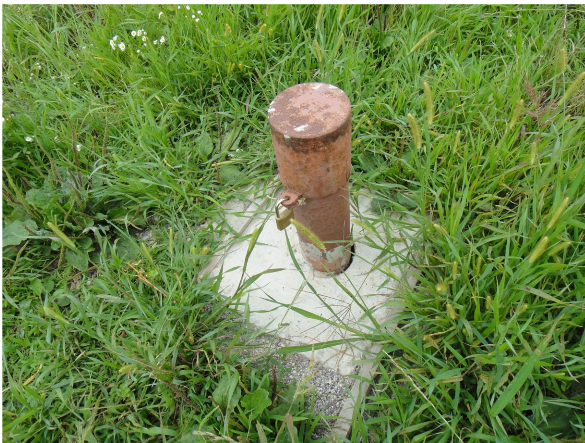
Merilna postaja za spremljanje podzemne vode v Skopicah na Krškem polju Groundwater measuring station Skopice on Krško polje
