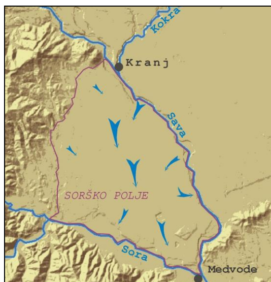
Slika 1. Generalne smeri toka podzemne vode v vodonosniku Sorškega polja Figure 1. General directions of groundwater flow in Sorško polje aquifer
