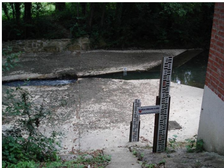
Slika 1. Nizko vodno stanje v juliju na merilnem mestu izvira Rižane (Foto: N. Trišič) Figure 1. Low water state in July on Rižana spring measuring station (Photo: N. Trišič)
