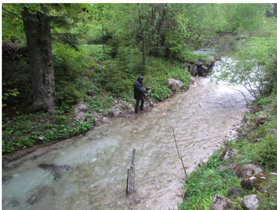
Slika 1. Meritev pretoka na območju izvira Završnice 13. maja 2014 (Arhiv ARSO) Figure 1. Završnica spring discharge measurement on 13th of May 2014 (ARSO archive)
