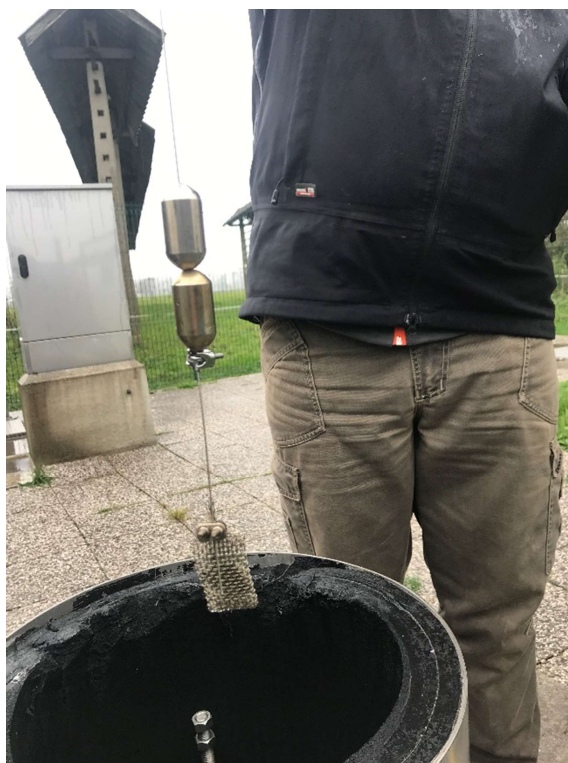
Slika 1. Nameščanje pasivnega vzorčevalnika v vodonosnik Radovljiškega polja, november 2019 Figure 1. Passive sampler installation in Radovljiško polje aquifer, November 2019
