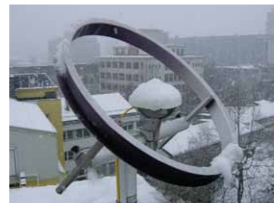
Slika 24. Zasneženi piranometer za difuzno sevanje v Ljubljani 18. marca 2008 zjutraj (levo) in časovni potek globalnega in difuznega sevanja istega dne (desno). Malo po 8. uri je bil piranometer za difuzno sevanje očiščen in je do 10.30 kazal bistveno večjo gostoto toka od še vedno zasneženega piranometra za globalno sevanje. Kasneje se je sneg naglo stalil in od 11.30 dalje so bili izmerki obeh piranometrov pravilni.
