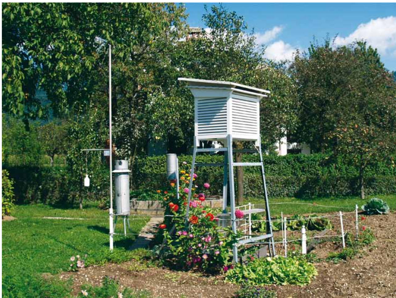
Slika 1. Tipična podnebna postaja z angleško meteorološko hišico (Hlebce pri Lescah)
